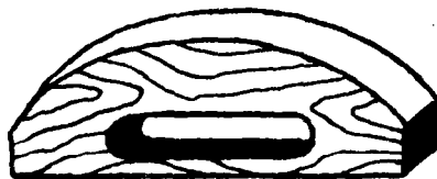
Рис. 19. Приспособление для нанесения вошины на проволоку в виде брусочка
